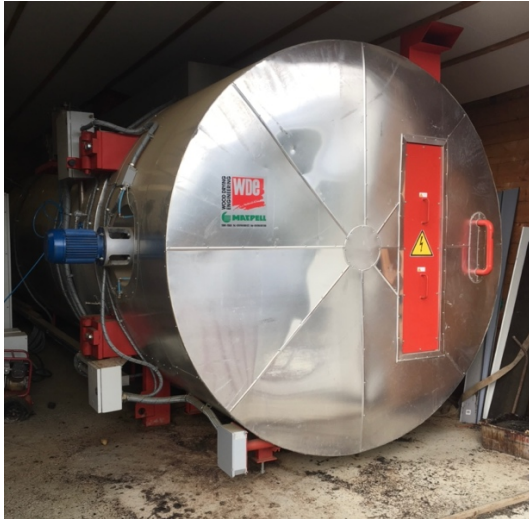
Vakuum-varmebehandlingsanlegg ved Sæteråsen Sag i Harstad. (Foto: C. Bersvendsen)
